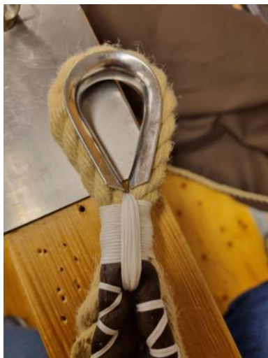
Het oog van de linker bovenhoek is uitgerust met een zeilkous van rvs.
