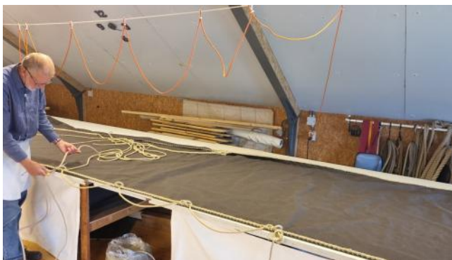
De lussen (litsen) worden aangebracht aan het uitgelegde zeil.
