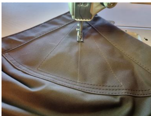
Beide onderhoeken worden met ruime waaivormige oplegstukken verstevigd.
