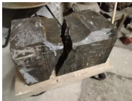
Twee gebroken halstenen: de linker in 2013 en de rechter 9 jaar later. Oorzaak: onregelmatige slijtage aan de hals van de gietijzeren as. (foto's: Geert van Stekelenburg)
