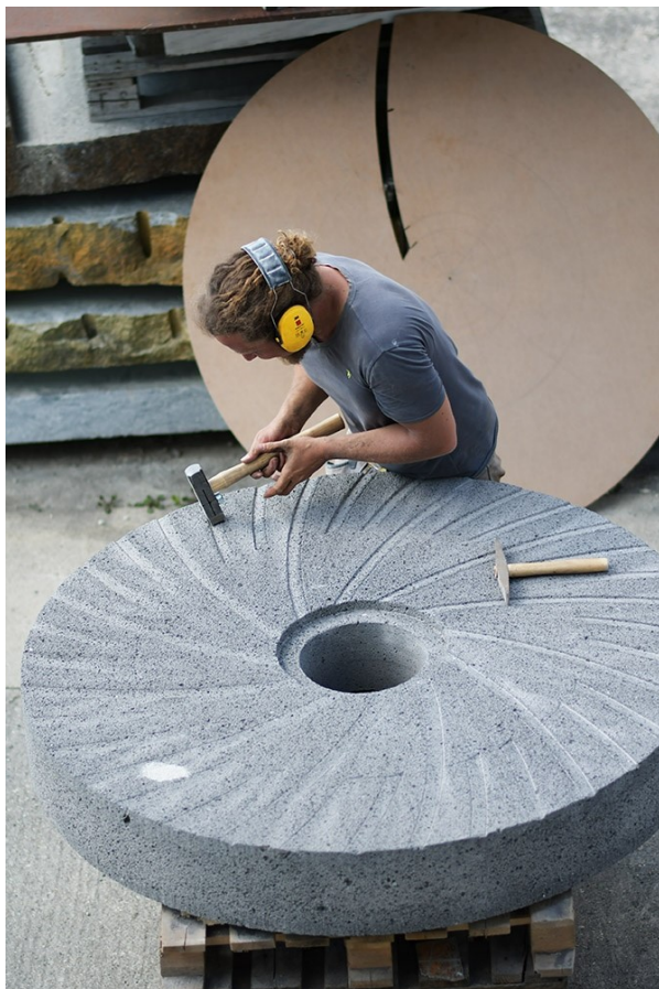
In de werkplaats van de 'Kleine Steinhauerei' wordt het bodemsel van een molensteen bewerkt met de kneushamer. Op de achtergrond zien we een mal voor het aanbrengen van nieuw scherpstel. (foto www.kleinsteinhouerei.de )
