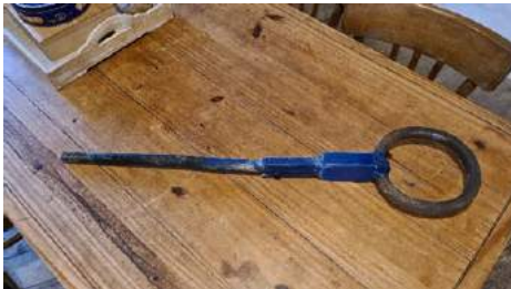
Verlengde en gerepareerde ring, die weer in de muur geplaatst kan worden.
