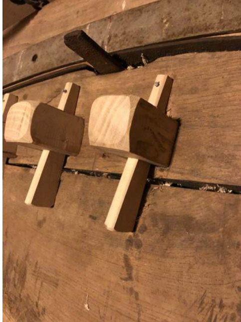
De door middel van spieën geborgde kammen van het bovenwiel. Elke spie wordt weer geborgd door een spijker. (foto: Willem Boender)
